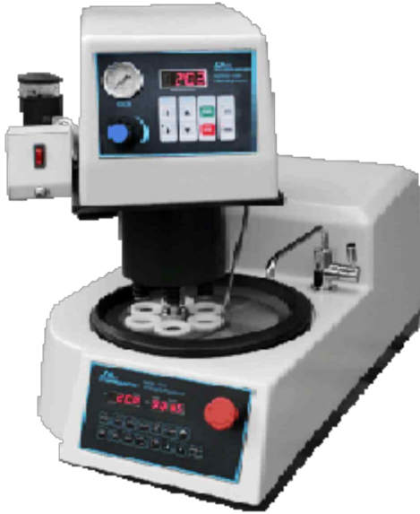
Figure 5-17 Disk-on-disk 회전방식을 사용한 자동 폴리셔 Disk-on-disk 방식의 경우, 시편을 고정 한 디스크와 연마디스크의 상대방향은 본체 연마 휠과 같은 방향 이거나 반대방향으로 회전될 수 있다 (그림 5-18).
