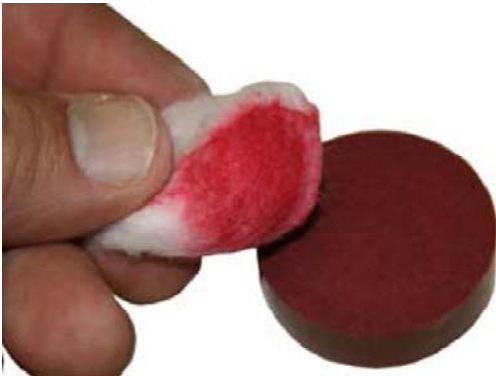
Figure 4-17 페놀Resin 성형 시 성형시간이 불 충분하면 알코올과 접촉 시 녹는 현상이 발생한다.
